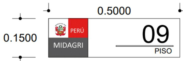
(\*) Para la presente actividad se debe tener en cuenta que el tablero irá suspendido en techo, el falso cielo raso esta ubicado a una altura de 2.40m de piso terminado.
