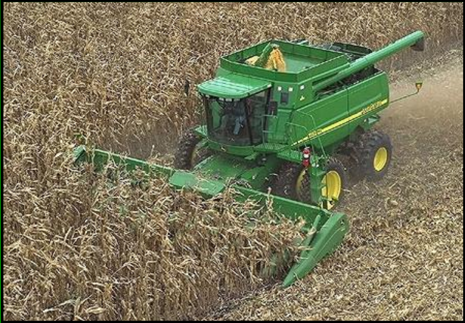
Cosechadora trilladora con cabezal para maíz
